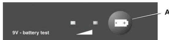
**NOTA:** Ambos LED apagados indican pilas usadas o no instaladas.
